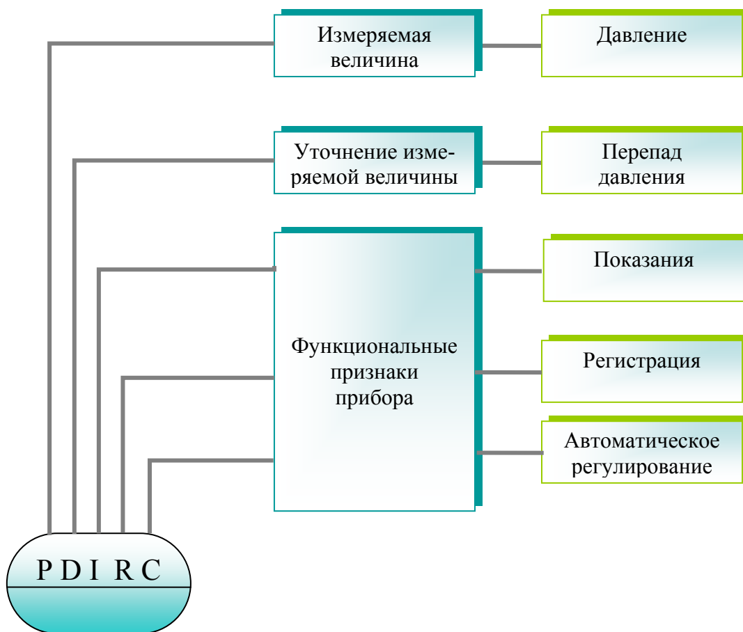
Рисунок 8 - Пример построения условного обозначения прибора на функциональной схеме.
